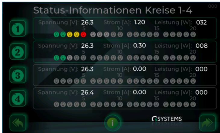
Abbildung 7-8: Statusinformationen der Leuchtenkreise
