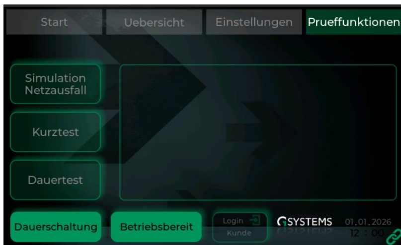
Abbildung 7-38: Übersicht der Prüffunktionen
